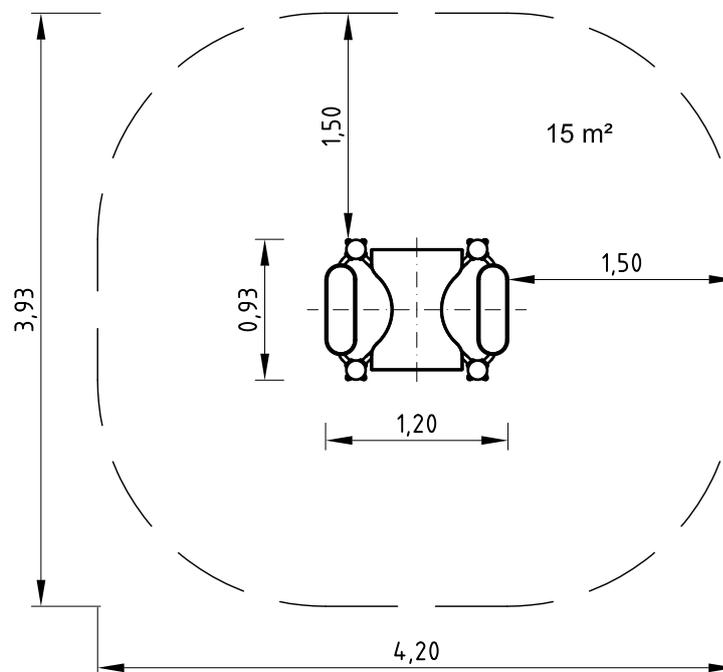
1. Standort für das werkseitig vormontierte Gerät unter Berücksichtigung des Platzbedarfs wählen.
