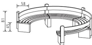
Innensitzer mit Rückenlehne (15 x 3,5 cm) und innerer Blendleiste, Rückenlehnholme aus langlebigem FSC-zertifiziertem Hartholz mit gerundetem Kopf als konstruktiver Holzschutz vor stehendem Wasser. Sichtbetonfüße zementgrau (T48 / B 14 / H 55 cm). Erdverankerung ca. 18 cm tief. Sonst wie Art. 7827-E0000FSCN.
