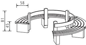
Außensitzer mit Rückenlehne (15 x 3,5 cm) und äußerer Blendleiste, Rückenlehnholme aus langlebigem FSC-zertifiziertem Hartholz mit gerundetem Kopf als konstruktiver Holzschutz vor stehendem Wasser. Sichtbetonfüße zementgrau (T48 / B 14 / H 55 cm). Erdverankerung ca. 18 cm tief. Sonst wie Art. 7827-E0000FSCN.
