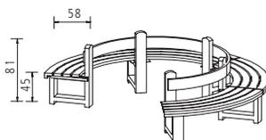
Außensitzer mit Rückenlehne (15 x 3,5 cm) und äußerer Blendleiste, Stahlfuß (T 58 / B 14 cm) mit Rückenlehnenholm, sonst wie Art. 7823-F0000FSCN.
