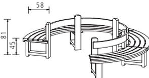
Außensitzer mit Rückenlehne (15 x 3,5 cm) und äußerer Blendleiste, Holzfuß (T 54,5 / B 14 cm) mit Rückenlehnenholm mit gerundetem Kopf als konstruktiver Holzschutz vor stehendem Wasser, sonst wie Art. 7828-F0000FSCN.
