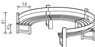
Innensitzer mit Rückenlehne (15 x 3,5 cm) und innerer Blendleiste, Holzfuß (T 54,5 / B 14 cm) mit Rückenlehnenholm mit gerundetem Kopf als konstruktiver Holzschutz vor stehendem Wasser, sonst wie Art. 7828-F0000FSCN.
