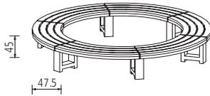
Hocker-Rundbank Mercur / Runge frei nach Maß. Innendurchmesser mind. 100 cm. Rundbank ohne Rückenlehne mit Sitzbelag aus langlebigem FSC-zertifiziertem Hartholz, naturbelassen (ohne Lasur). 4 radial geschnittene Sitzleisten 10 x 3,5 cm mit zusätzlicher innerer und äußerer Blendleiste von H 4,5 cm. Segmentumfang bis ca. 130 cm (radiusabhängig). Holzfußrahmen (T 44,5 / B 14 / H 41,5 cm) freistehend. Fußstreben mit Loch zur Befestigung optionaler Fundamentanker.
