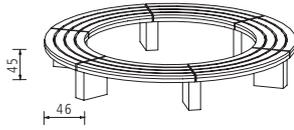
Hocker-Rundbank Mercur / Runge frei nach Maß. Innendurchmesser mind. 100 cm. Rundbank ohne Rückenlehne mit Sitzbelag aus langlebigem FSC-zertifiziertem Hartholz, naturbelassen (ohne Lasur). 4 radial geschnittene Sitzleisten 10 x 3,5 cm mit zusätzlicher innerer und äußerer Blendleiste von H 4,5 cm. Segmentumfang bis ca. 130 cm (radiusabhängig). Sichtbetonfüße zementgrau (T 36 / B 14 / H 55 cm). Erdverankerung 15 cm tief.
