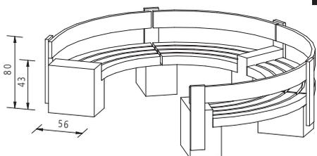
Innensitzer mit Rückenlehne (18 x 3,5 cm) und innerer Blendleiste. Rückenlehnholm mit abgerundetem Kopf als konstruktiver Holzschutz vor stehendem Wasser, sonst wie Art. 7527-E0000FSCN.
