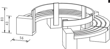
Außensitzer mit Rückenlehne (18 x 3,5 cm) und äußerer Blendleiste. Rückenlehnholm mit abgerundetem Kopf als konstruktiver Holzschutz vor stehendem Wasser, sonst wie Art. 7527-E0000FSCN.
